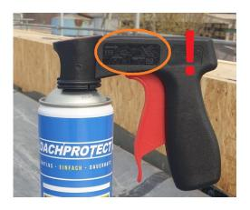
Achten Sie darauf, die Düse auszurichten. Durch die Haltung der Spraydose kann ohne Probleme ein Sprühstrahl im Abstand von 30 cm gehalten werden und ein paralleler Auftrag mit 1 bis 2 cm Überlappung erfolgen.
