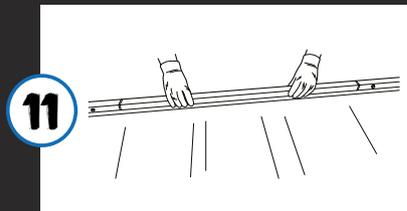
11 Profil mittig ansetzen, dass auf jeder Seite ca. 2 - 3 mm Spalt entstehen. Nun Profile an der Frontseite verschrauben.
