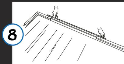
8 Nun an der Dachfront zur zweiten Außenecke vorarbeiten, zweite Außenecke auflegen, Restlänge ermitteln und einkürzen.
