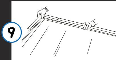
9 Zweite Außenecke samt Verbinder mit dem gekürzten Profil verbinden und auflegen.
