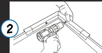
2 Dann mittels zwei Trapezblechschrauben von der Innenseite befestigen. Verbinder sollen freigängig bleiben (Ausgleich für thermische Ausdehnung).
