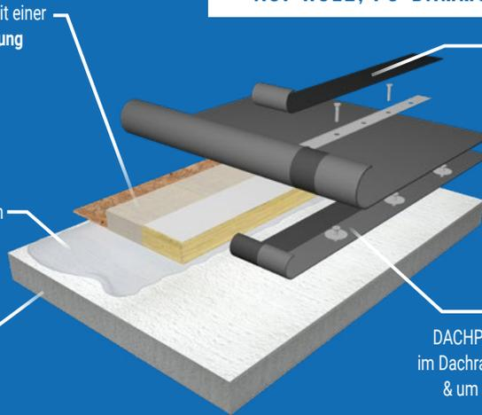
lineare Befestigung mit geeigneten Schienen, z. B. EJOT Flachdachprofil FP (verschraubt mit dem Untergrund) & Abdichtung mit Nahtabdeckband
